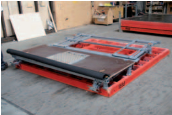
3. En atelier, bloquer la passerelle MXP (prestation effectuée par PERI).
