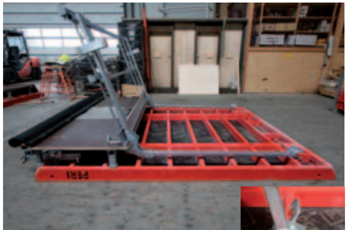
4. Sur chantier, déplier le garde-corps et faire pivoter la passerelle vers le haut.
