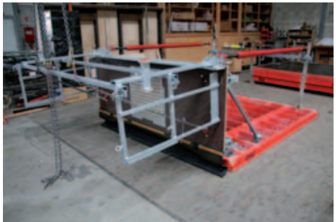
6. Sur chantier, monter les étais de réglage et les raidisseurs de base.
