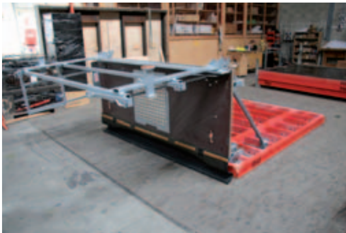
5. Sur chantier, fixer la diagonale dans le raidisseur.
