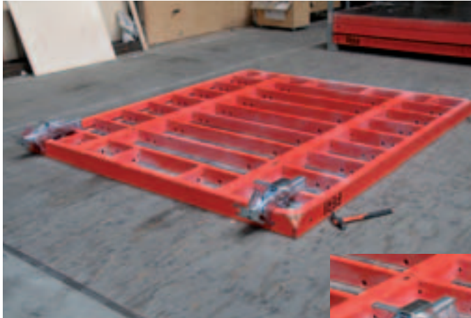
1. En atelier, monter le sabot de passerelle MXP dans les diagonales d'éléments.
