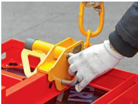
La capacité portante maximum est de 300 kg par crochet de levage LIWA.
